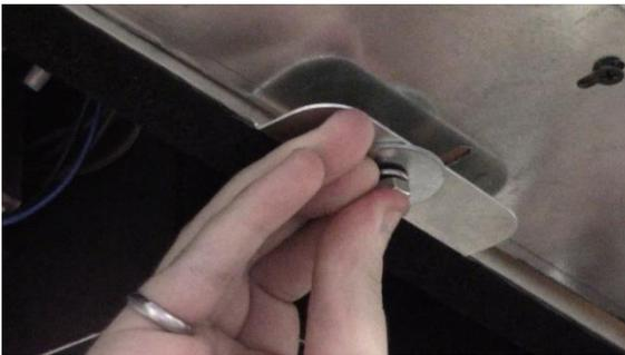
Fixez le support de montage aux quatre points de connexions filetées à l'aide d'une rondelle, d'une rondelle d'arrêt et d'un écrou, puis serrez.
