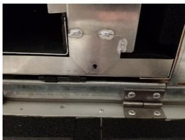
9. Réinstallez le bac de condensat en réinstallant le tube collecteur et en rebranchant le câble de commande.
