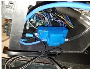
5. Retirez le tube de sa connexion au niveau du ramassage et débranchez le câble de commande sur le côté de la pompe comme indiqué. Le bac devrait maintenant être dégagé de l'unité de
