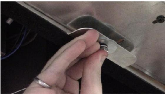
Befestigen Sie das Gehäuse an den vier Gewindeanschlusspunkten des Montagebügels, indem Sie die Unterlegscheibe, die Sicherungsscheibe und die Mutter anschrauben und festziehen.
