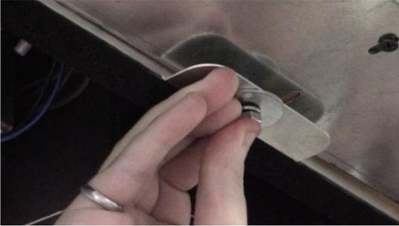
Atornille al soporte de montaje en los cuatro puntos de conexión roscados con una arandela, una arandela de seguridad y una tuerca, y ajustar.
