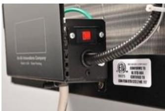
Il cavo di alimentazione è cablato in fabbrica sul lato del condensatore del sistema. Se è necessario il cavo sul lato della cantina per il collegamento a una presa disponibile, questo può essere ottenuto rimuovendo i cavi a 3 fili (terra inclusa) e spostando il cavo sulla staffa di controllo sul lato opposto e il filo che collega i cavi neri, fili bianchi e verdi ai cavi forniti dalla fabbrica. I fili devono avere le estremità tagliate e spellate per prime.
