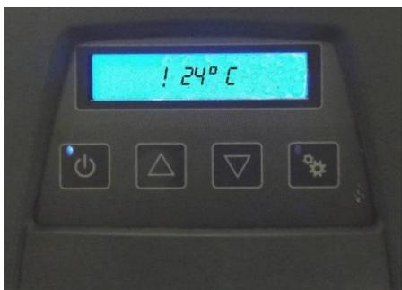
Quando si verifica una situazione d'allarme, il pannello di comando farà lampeggiare la retroilluminazione sul display oltre ad annunciare l'errore sullo schermo. L'utente può porre fine al lampeggiamento della retroilluminazione premendo un pulsante sull'interfaccia utente locale. Tuttavia, la segnalazione d'allarme non scomparirà dal display finché l'errore non sarà risolto.
