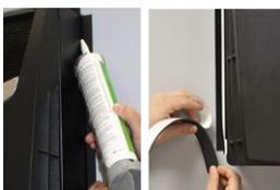
Sigillare i punti di giuntura tra il manicotto EasyMount™ e il sistema Wine Guardian sul lato delle flange del sistema con un sigillante in lattice per assicurare una chiusura ermetica ed evitare che il sistema si muova in orizzontale. Dopo la sigillatura, aggiungere le strisce isolanti autoadesive fornite nel kit al telaio e coprire le flange del manicotto per prevenire un possibile trasudamento.
