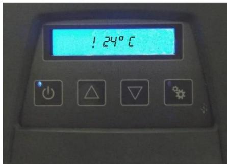
Cuando se produce una advertencia de alarma, el control encenderá la luz de fondo en la pantalla además de anunciar el fallo real en la pantalla. El usuario puede parar la luz de fondo pulsando un botón en la interfaz de usuario local. Sin embargo, la advertencia de alarma no se borrará en la pantalla hasta que se corrija el fallo.
