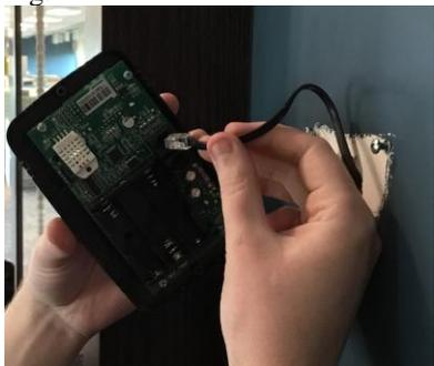
1. Desconecte el cable de comunicación del lateral de la unidad Wine Guardian y el controlador de interfaz remota. (Fig. 1)
