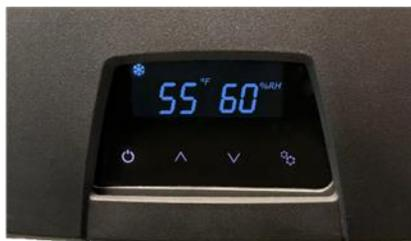
Interfaz de usuario local: Se puede utilizar con el control principal para ajustar la configuración, leer la temp/humedad y leer los códigos de fallo en la unidad.
